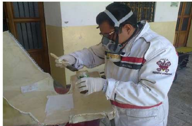
Figura 12. Colocación de la fibra de yute y resina.
