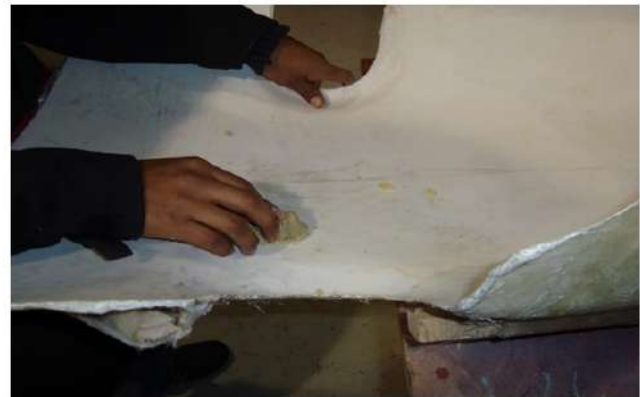
Figura 11. Colocación de la cera desmoldante.
