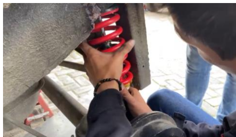
Figura 18. Modificación de la suspensión
