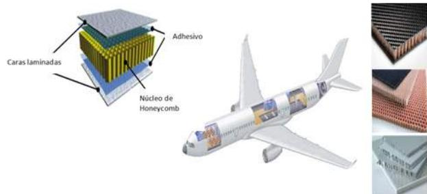
Figura 12. Estructura compuesta tipo sándwich (honeycomb)
