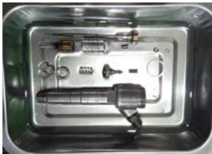
Figura 11. Limpieza del inyector Bosch
