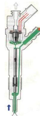
Figura 2. Funcionamiento de sistemas interno del inyector CRDI
