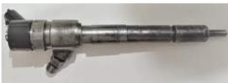
Figura 4. Inyector CRDI Bosch 044 5110 310
