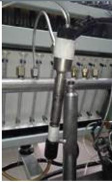
Figura 6. Comprobación de fuga externa del inyector Bosch 044 5110 310
