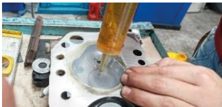
Figura 3 Cubicación de la cámara de combustión
