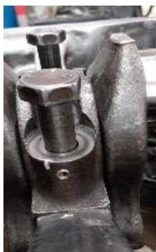
Figura 11. Reforzamiento de bancada con prisioneros
