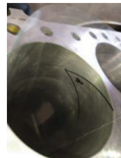
Figura 9. Comprobación del ángulo de bruñido
