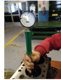
Figura 8. Rectificado del cilindro a 0.040” (79 mm diámetro final)
