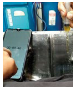
Figura 16. Prueba de recorrido de aceite en las paredes del bloque
