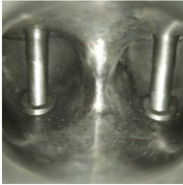
Figura 5. Recorte de guías de válvulas de admisión
