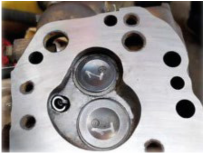
Figura 1. Pulido de la cámara de combustión
