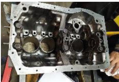
Figura 7. Pulido de las paredes internas del bloque
