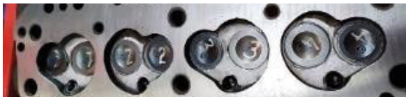
Figura 2. Rectificado de la superficie plana de la culata
