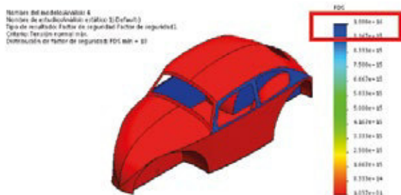
Figura 10: FDS del chasis Volksrod
