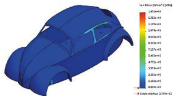
Figura 3: Tensiones Equivalentes del chasis Volkswagen
