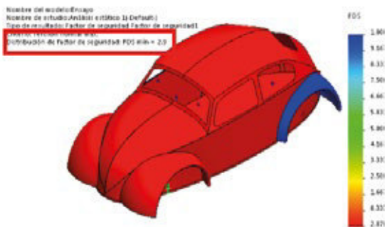
Figura 6: FDS del chasis Volkswagen
