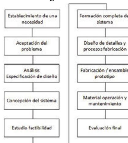
Figura 1. Proceso de diseño
