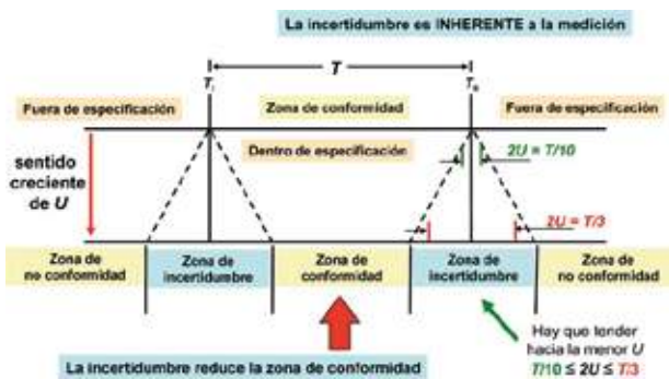
Figura 1. Tolerancia de diseño e incertidumbre de una medida.
