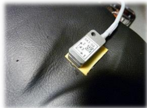
Figura 9. Posicionamiento del sensor de medición de vibraciones en el asiento de los vehículos. Notar el posicionamiento de los ejes.
