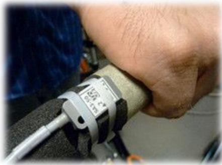
Figura 10. Sensor de vibraciones en posición para el manubrio de los vehículos
