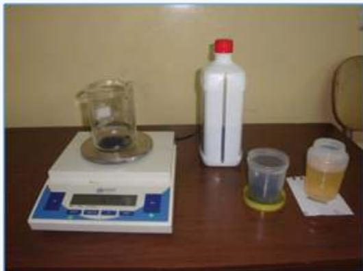
Figura 4. Equipo utilizado para preparación del fluido MR
