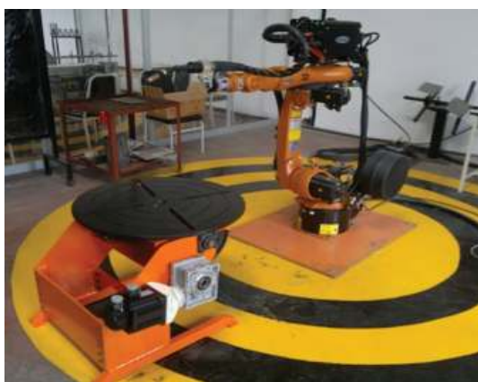
Figura 8. Mesa posicionadora de soldadura en dos ejes para el brazo robótico KUKA KR5ARC
