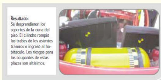
Figura 3 Cilindro de gas después de prueba de impacto instalación casera
