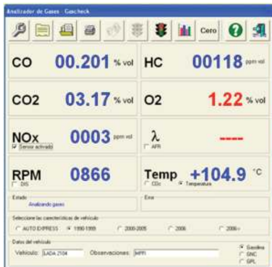
Figura 10 Análisis de gases (MPFI)
