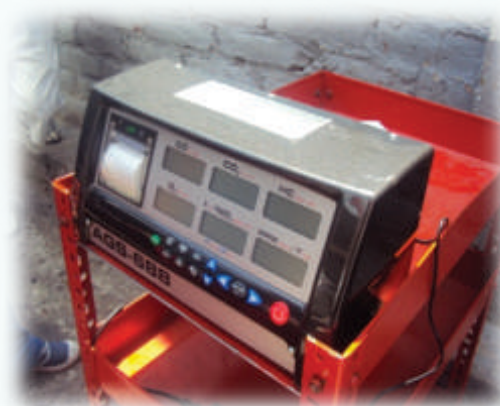
Figura 3. Analizador de Gases de escape
