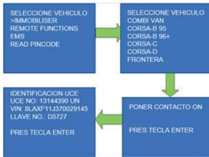
Figura 7. Verificación del scanner
