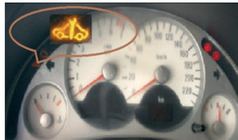
Figura 4. Testigo del sistema inmovilizador del vehículo
