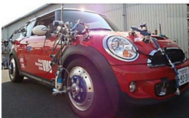
Figura 4. Vehículo instrumentado para la obtención de la ecuación de carga de carretera. [1]
