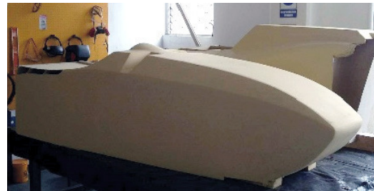
Figura 14. Acabado del molde
