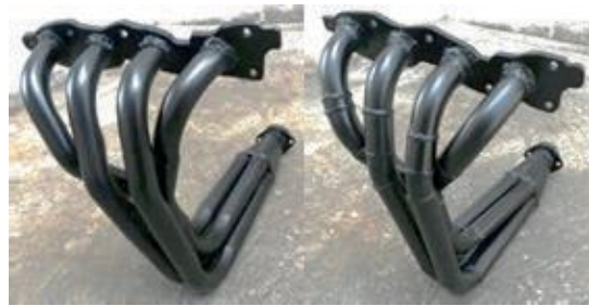
Figura 10. Múltiple de escape 4-1, tipo A (izquierda), Múltiple de escape 4-1, tipo B (derecha)
