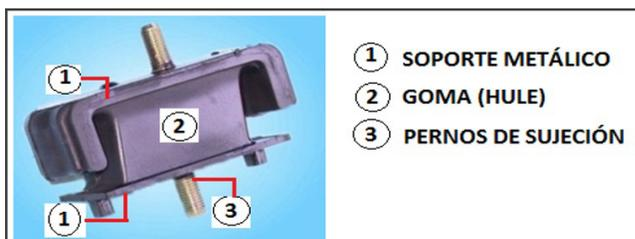
Figura 2. Elementos de la base motor
