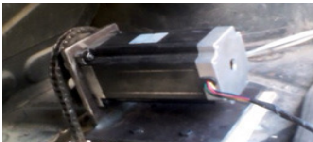
Figura 11. Fijación del actuador de la dirección posterior
