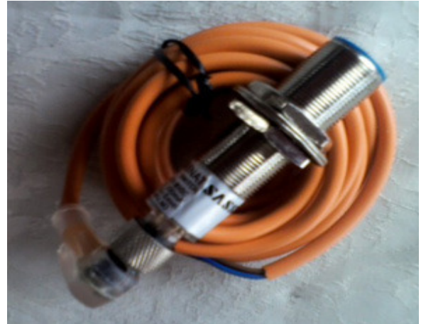
Figura 7. Sensor magnético para velocidad del vehículo.
