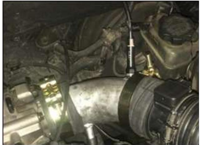
Figura 3. Implementación del conducto de admisión diseñado para la inyección de metanol [5]
