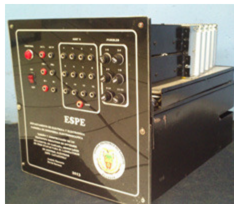
Figura 5. Módulo final del Inversor Multinivel Didáctico Monofásico en Cascada
