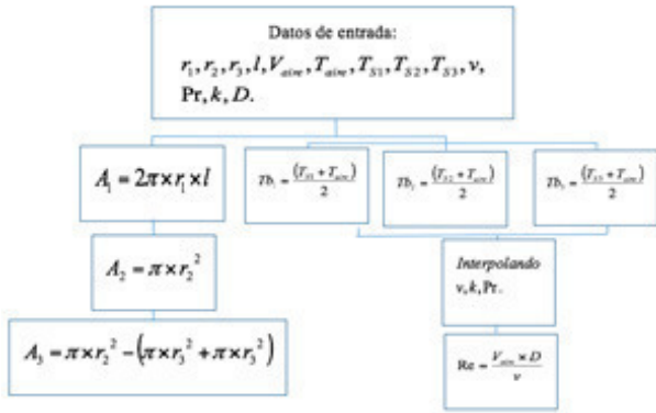
Figura 3. Algoritmo de cálculo del calor perdido por transferencia (convección)
