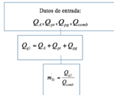
Figura 5. Algoritmo de cálculo del consumo de diésel en el quemador
