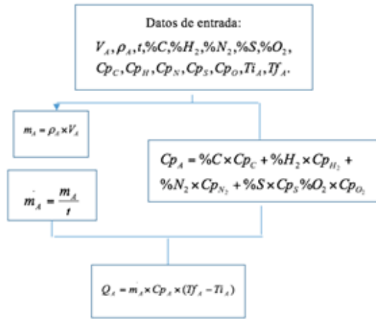
Figura 1. Algoritmo para el calor absorbido por el asfalto.
