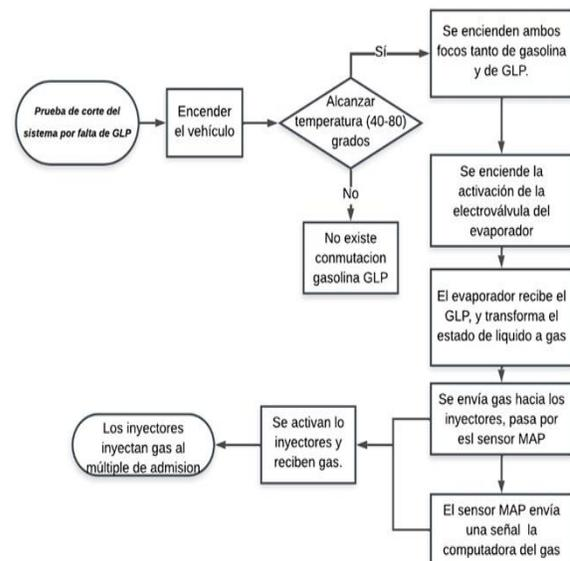
Nota. En la imagen se muestra como está establecido el protocolo de prueba de inyección de GLP, es importante recordar sus condiciones de funcionamiento.
