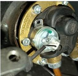
Figura 5. Indicador mecánico de nivel de GLP.
