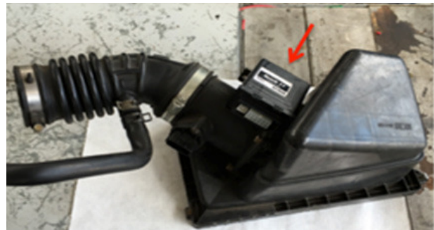
Figura 2. Instalación del variador Spark 11
