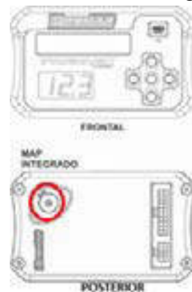
Figura 4. Sensor MAP integrado
