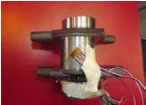
Figura 8. Cigüeñal instrumentado con roseta de deformación.
