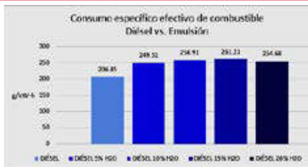
Figura 8. Consumo específico a máxima carga de la prueba
