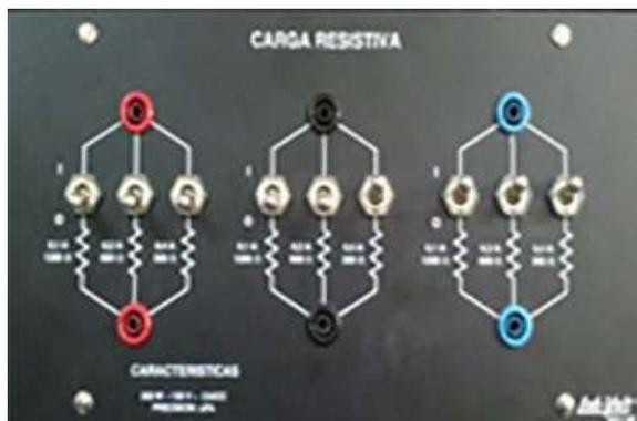
Figura 10: Módulo real de cargas resistivas
