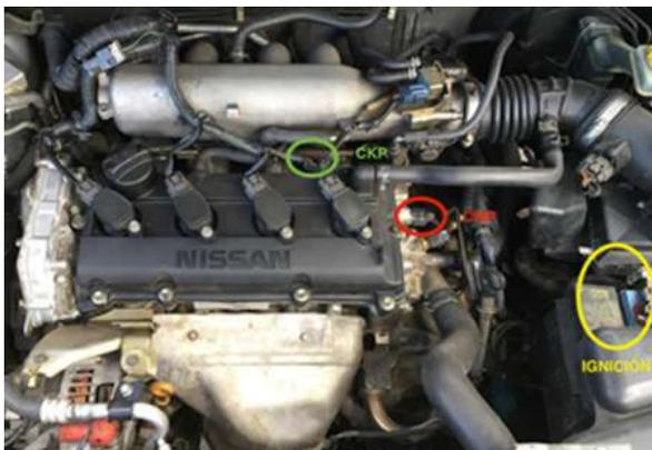
Figura 1. Ubicación de los sensores e ignición
