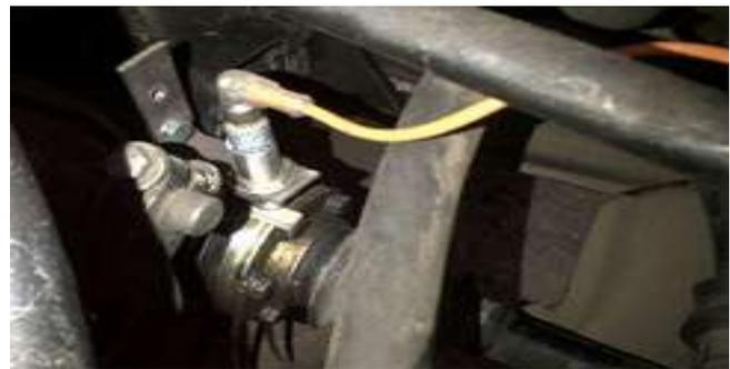
Figura 13. Ubicación del sensor de giro.
