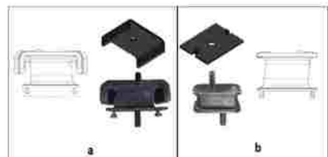
Figura 3. Modelos considerados para el diseño de una base motor.
