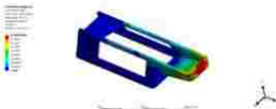
Figura 16. Deformación de la base a una frecuencia de 500 Hz
