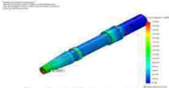
Figura 8. Tensión de Von Mises del eje del cabezal
