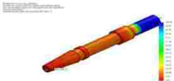
Figura 9. Factor de seguridad del eje del cabezal
