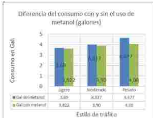
Figura 9. Diferencia de consumo de combustible en relación al tráfico de la prueba de ruta [5]
