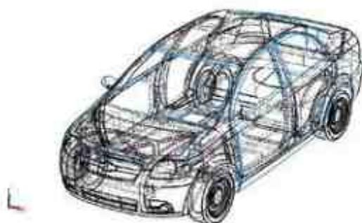
Figura 12. Cad vehículo Sedán-Estructura habitáculo de seguridad visible
