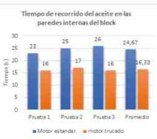
Figura 17. Valores de tiempo del recorrido de aceite sobre las paredes del block.
