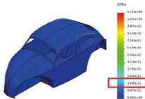
Figura 9: Deformación Unitaria del chasis Volksrod
