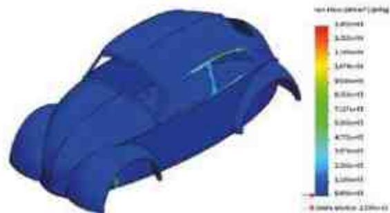
Figura 3: Tensiones Equivalentes del chasis Volkswagen
