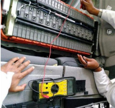
Figura 1. Medición de voltaje en batería de alto voltaje
