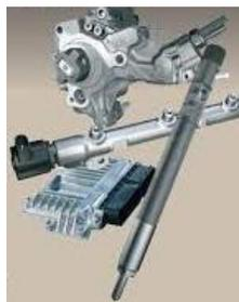
Figura 1. Inyector Delphi
