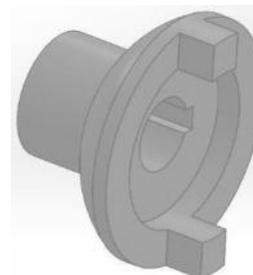
Figura 5.- Modelo del Acople Motor – Bomba
