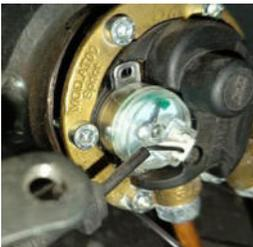
Figura 5. Indicador mecánico de nivel de GLP.
