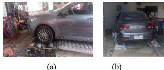
**Figura 5.** Montaje del vehículo Kia Rio 1,4lt. en el dinamómetro marca Dynocom 5000 Series para las pruebas de calibración y validación de la programación del módulo de control electrónico Haltech Elite 1500.
