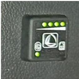
Figura 4. Indicador de nivel en el depósito de GLP
