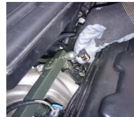
Fig. 17 Verificación del inyector
