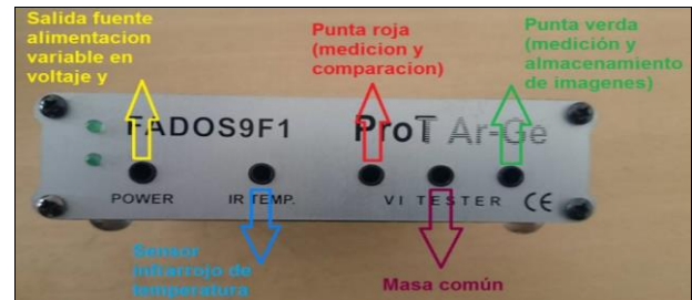
Fig. 11 Parte frontal del analizador y osciloscopio multifunción de pruebas voltaje-corriente
