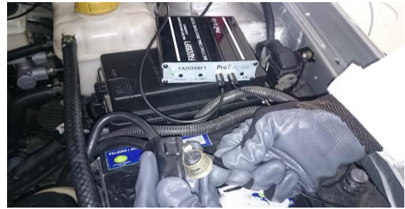
Fig. 16 Conexión de la masa del equipo al cable negativo que conecta a la batería
