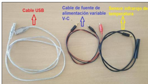
Fig. 14 Cables adicionales, USB, sensor de temperatura y fuente variable de alimentación DC
