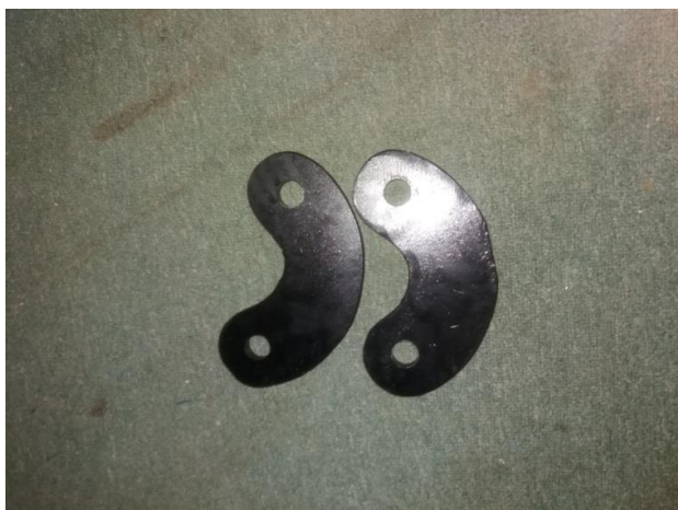
Fig. 18. Elemento de suspensión construida
