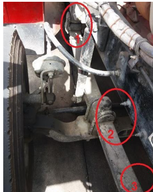
Fig. 10. Celdas de carga instaladas en la suspensión
