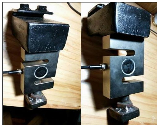
Fig 8. ensamblaje bases y celdas de carga
