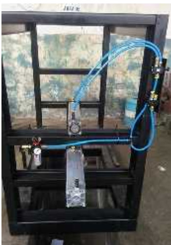
Figura 14. Red de distribución de fluido
