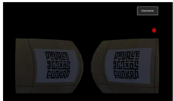
Fig.7. Visor de realidad aumentada incorporando Cardboard
