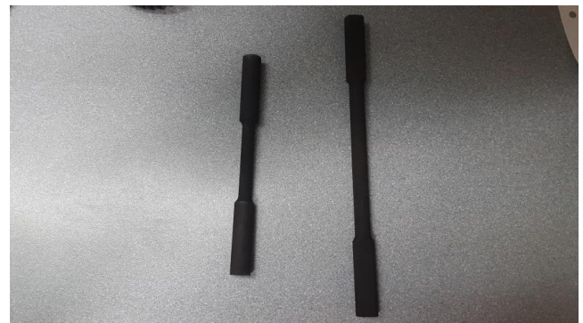
Figura 5 Probetas después de tratamiento térmico
