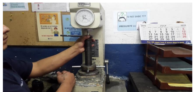
Figura 6 Medición de la dureza de la probeta de torsión
