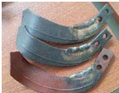
Fig. 10. Aspas añadidas material
