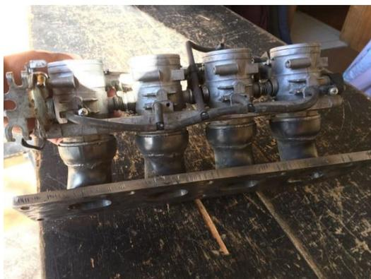
Fig. 6. Colocar de los ITBS en la base de admisión diseñada
