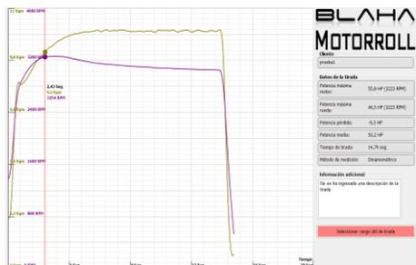
Fig. 15. Curva de torque del motor Suzuki 1300 estándar
