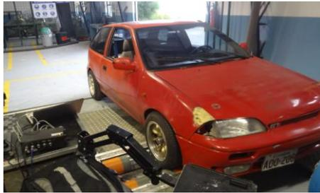
Fig. 8. Vehículo centrado en el banco dinamométrico
