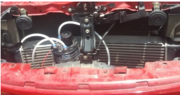
Fig. 2: Instalación generador de hidrógeno en el motor de 3000 cc
