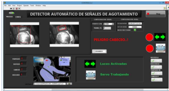
Fig.17. Prueba en estado cabeceo del conductor.
