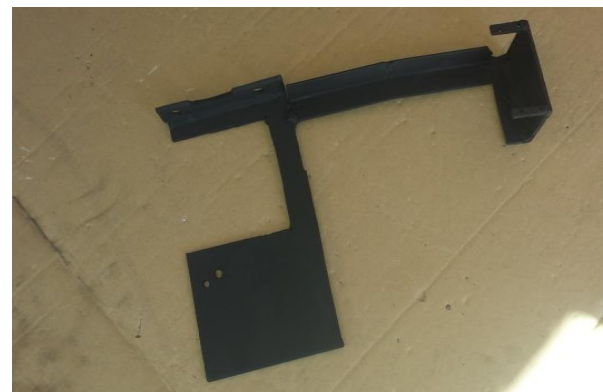
Fig. 2. Diseño del soporte del servomotor
