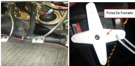
Fig.12. Ubicación del servomotor y soporte.
