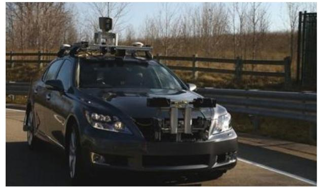
Fig.3. Auto prototipo con sensores frontales para detectar obstáculos y una cámara de largo alcance.
