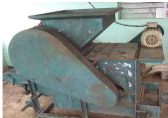
**Fig. 1 Máquina descascaradora.**
