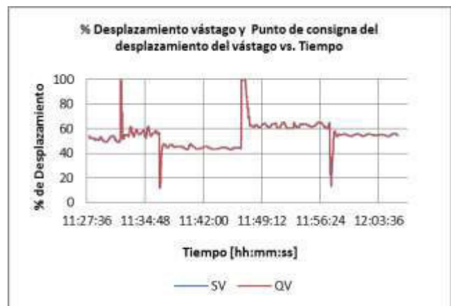
Fig. 5 Datos HART: porcentaje de desplazamiento vástago (QV) y punto de consigna de desplazamiento del vástago (SV).
