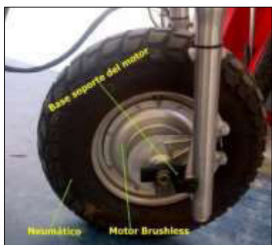
Fig. 10. Instalación del motor
