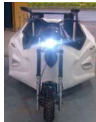
Fig. 12. Implementación de luces led
