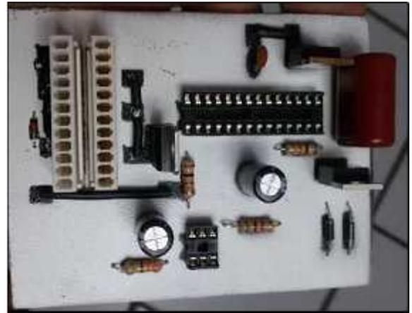
Figura 2. Módulo de inyección y encendido terminado
