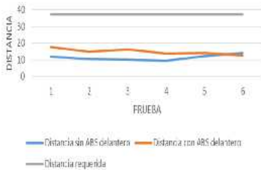
Figura 5. Distancias de frenado con ABS y sin ABS freno delantero
