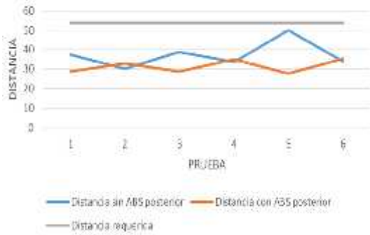
Figura 6. Distancias de frenado con ABS y sin ABS freno posterior
