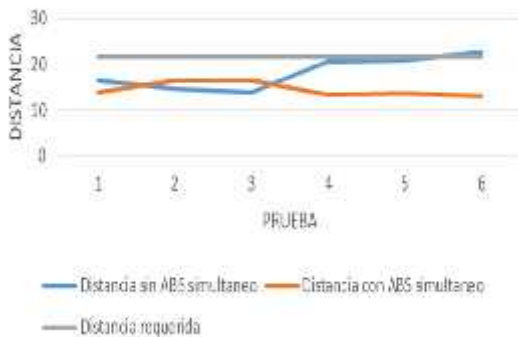
Figura 7. Distancias de frenado con ABS y sin ABS freno simultaneo
