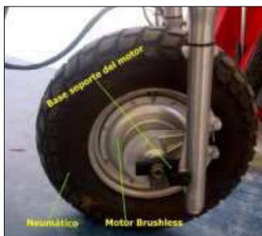
**Fig. 10. Instalación del motor**
