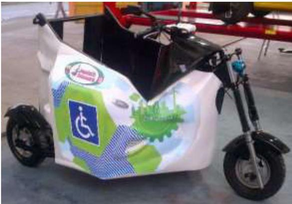
Fig. 1. Triciclo monoplaza eléctrico
