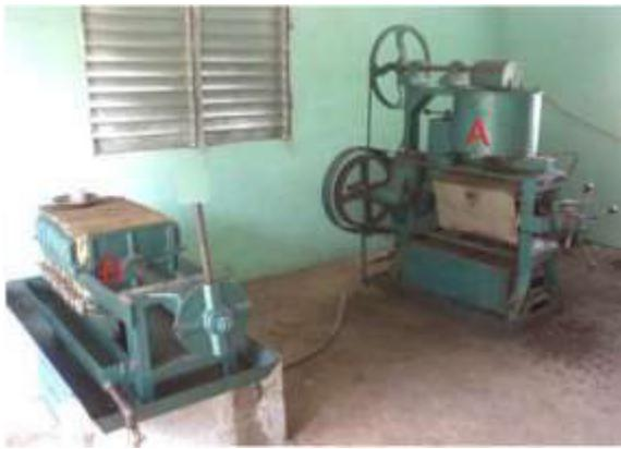
**Fig. 2 Sistema máquina extractora (A) – filtros (B).**
