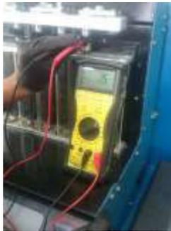
Fig. 6. Medición de la resistencia de los inyectores
