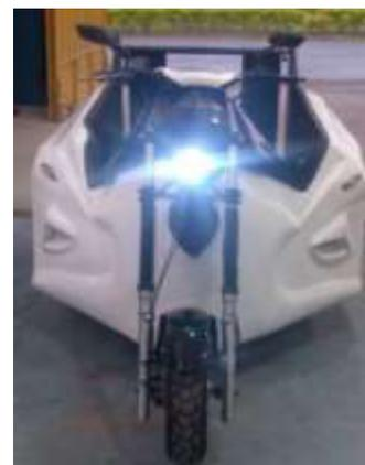
**Fig. 12. Implementación de luces led**
