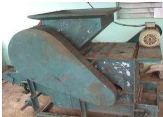
**Fig. 1** Máquina descascaradora.
