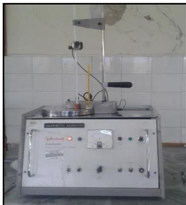
Figura 4. Bomba calorimétrica adiabática
