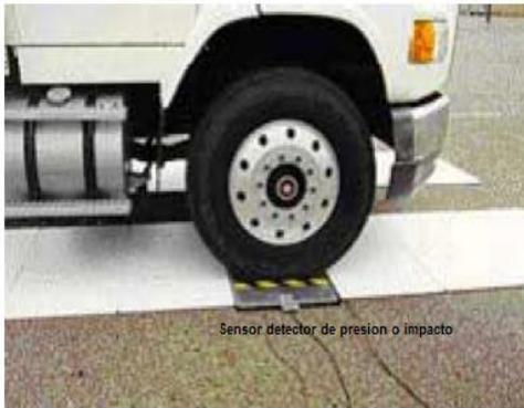
Fig. 2. Sensor de impacto o presión
