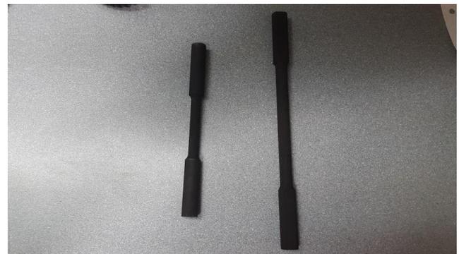
Figura 5 Probetas después de tratamiento térmico
