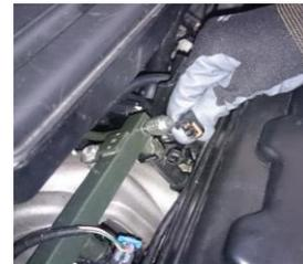
Fig. 17 Verificación del inyector
