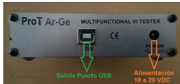
Fig. 12 Analizador y osciloscopio multifunción de pruebas voltaje-corriente
