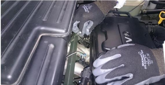
Fig. 20 Ubicación de la masa del equipo a una de las terminales del inyector
