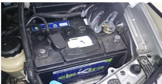
Fig. 15 Desconexión de la alimentación eléctrica del vehículo
