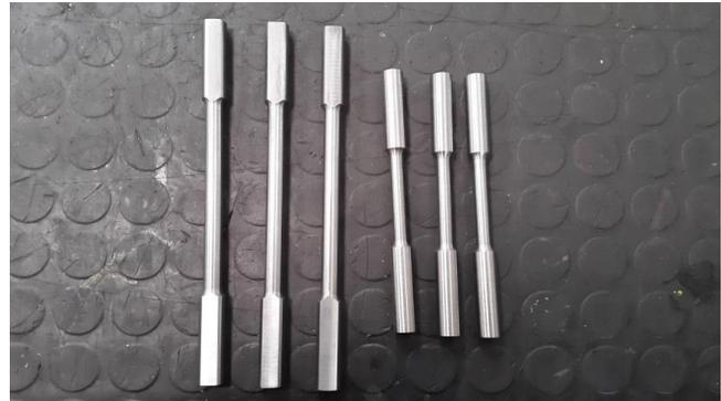
Figura 4 Probetas maquinadas
