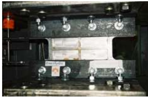
(b) Disipador antes del ensayo.
